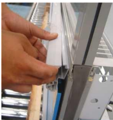
Рис. 3. Отсоедините отбойник от держателя, правильно применив силу
