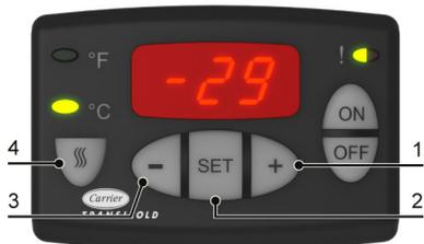
1. Для доступа к функциональным параметрам на экране по умолчанию нажмите и удерживайте одновременно нажатыми клавиши **DEFROST** (4) / + (1) / - (3).
